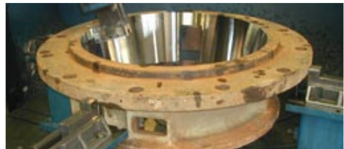
Aufschweißen von Kreiselschneckenoberteil mit anschließender mechanischer Bearbeitung
