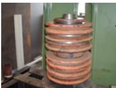
Überholung von wartungsfreiem Unterwasserrollenblock
